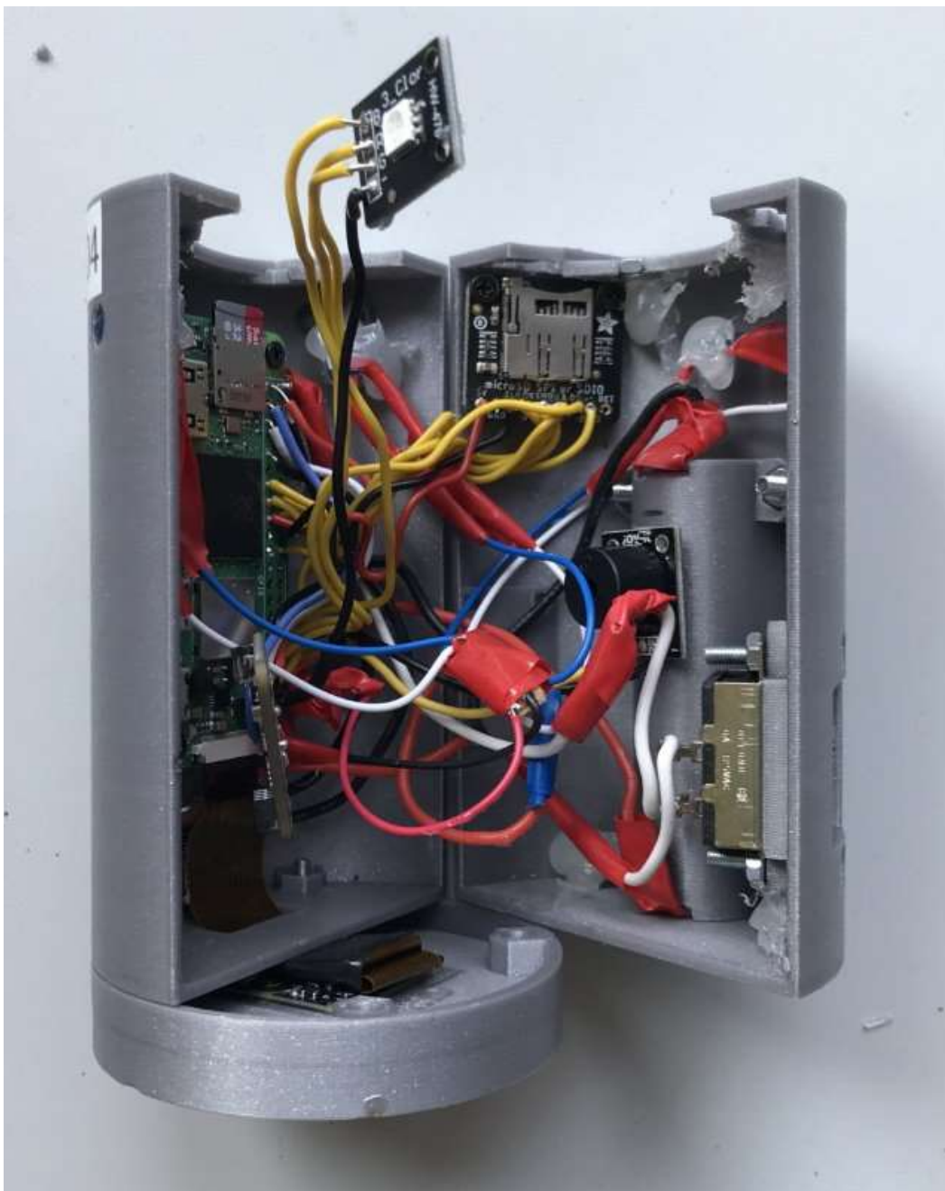
Blick ins Herz des Cansat. Die Hülle wurde am neuen 3-D-Drucker der LuO gedruckt.
